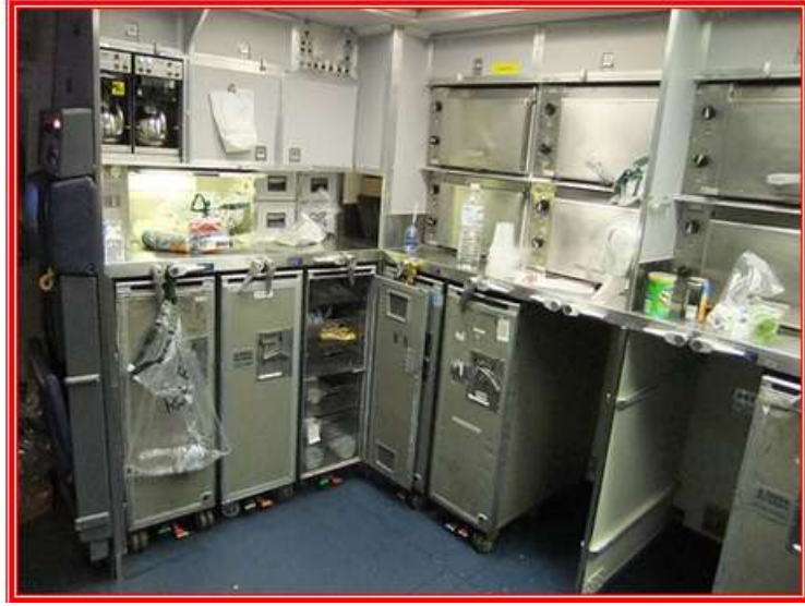
Resim 2. 5: Geniş gövdeli uçaklarda ikisi MID bölümünde (orta kabin) karşılıklı olmak üzere 4 adet galley (mutfak) bulunur.
