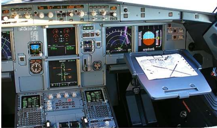
Resim 1. 1a: Dar gövdeli uçakların bilgisayar sistemi ve joistik ile idare edilir. Joistikler kaptanın solunda ve First Officer'in sağ tarağında yer alır.
